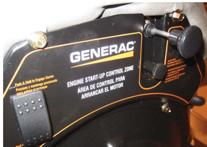
Schéma 19 - Position d'étrangleur plein
