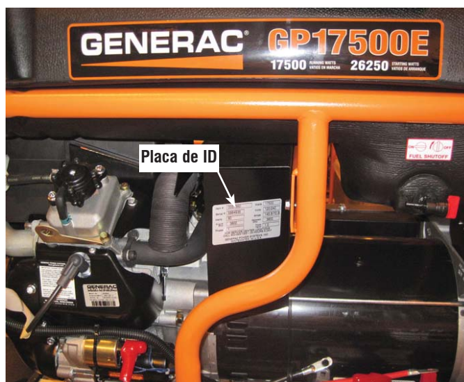
Figura 1 - Paca de ID del generador
