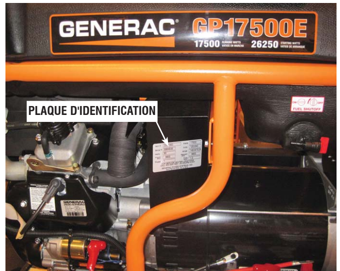
Schéma 1 - Plaque d'identité du générateur
