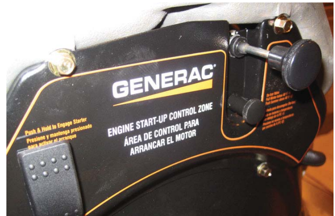
Figura 19 - Posición Full Choke
